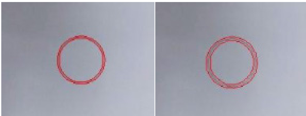
Figura 7 - Contorno externo e interno da circunferência para o caso sem aplicação de filtro para suavização (esquerda), e para o caso com aplicação de filtro gaussiano de dimensão 11x11 (direita).
