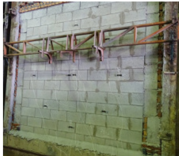
Fotografia 6 - Ensaio de resistência ao fogo em parede sem função estrutural
