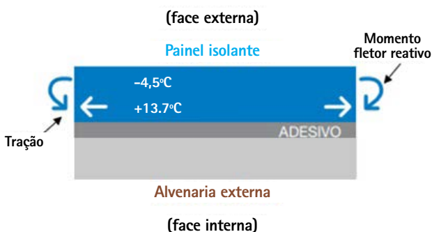
Figura 3 – Comportamento do EPS com sua deformação controlada
