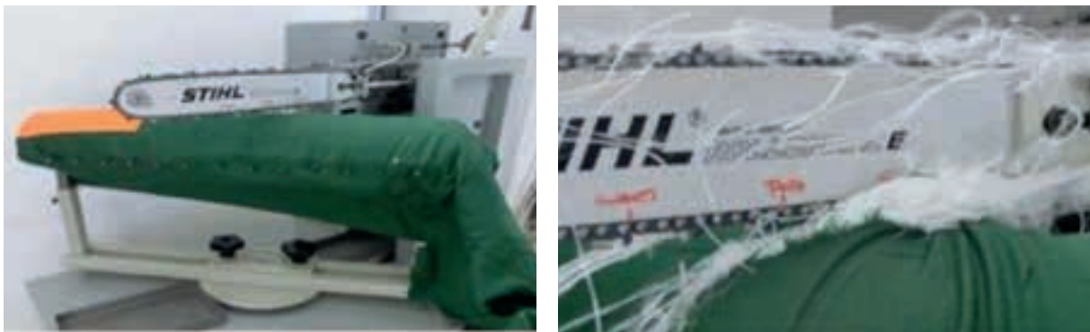
Figura 5 – Ensaio de corte por motosserra sendo realizado
