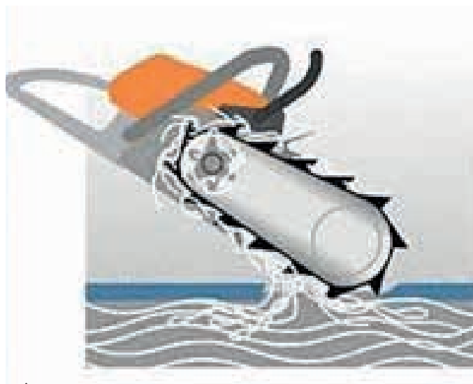
Figura 1 – Ensaio de corte realizado em EPI utilizando como princípio a obstrução da corrente de corte
